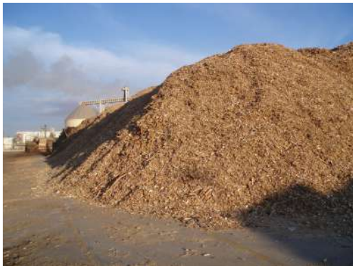
Obtención de astillas procedentes de residuos de madera utilizados para la fabricación de tableros Cortesía: ANFTA (Asociación Nacional de Fabricantes de Tableros)
