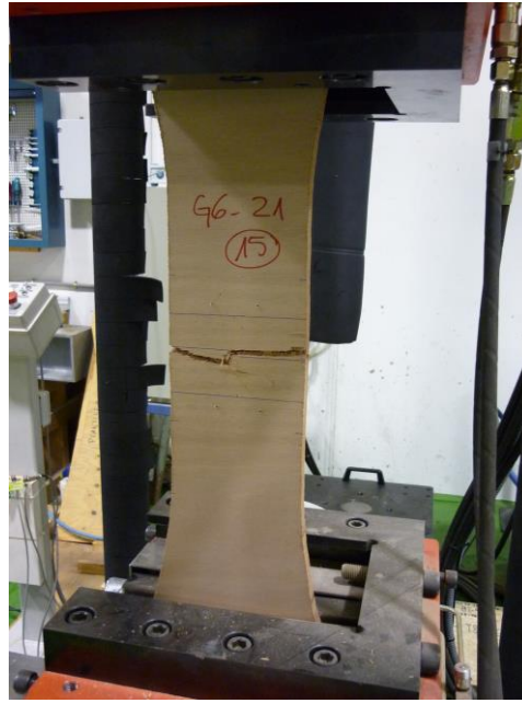
Fotos: Ensayos de Compresión y Tracción (EN 789) para la caracterización de Tableros Contrachapados Estructurales. Cedidas por el Laboratorio de Productos de Madera para la Construcción, ICIFOR, INIA- CSIC.
