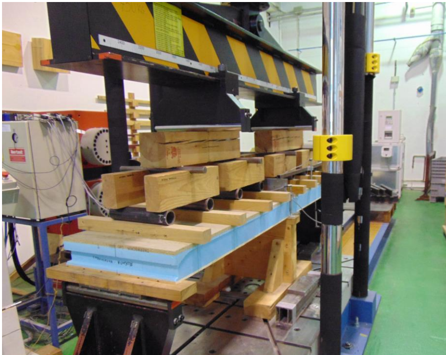
Foto: Ensayo de Flexión de Paneles Sándwich. Cedidas por el Laboratorio de Productos de Madera para la Construcción, ICIFOR, INIA- CSIC.
