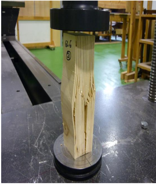
Fotos: Ensayos de Compresión y Tracción (EN 789) para la caracterización de Tableros Contrachapados Estructurales. Cedidas por el Laboratorio de Productos de Madera para la Construcción, ICIFOR, INIA- CSIC.
